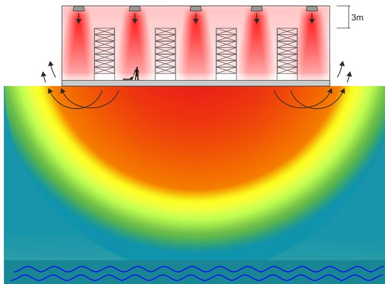
Bei einer Lagerfläche von  $6.000 \text{ m}^2$  gewinnen Sie  $18.000 \text{ m}^3$  Raumvolumen, weil bei Dunkelstrahlern und Luftherizern (unter der Decke) ein Abstand von 3 m zu den Regalen eingehalten werden muss.
