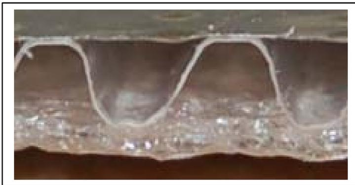
$$\text{aus Aufbau 2: } \lambda_{\text{Folie+Kontakt}} = \frac{s}{\underbrace{R_{\text{Folie}} + R_{\text{Kontakt}}}} = \frac{0,0032}{0,0808} = 0,040 \frac{\text{W}}{\text{m K}}$$
