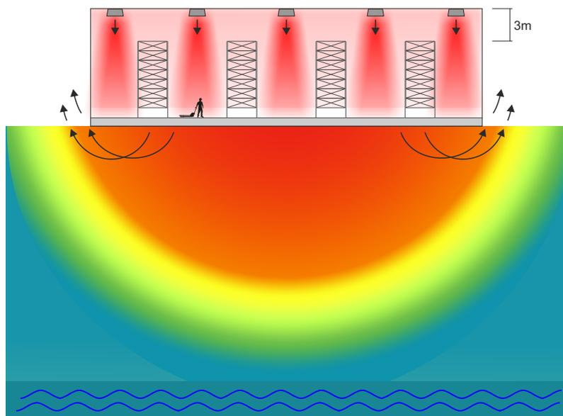
Bei einer Lagerfläche von  $6.000 \text{ m}^2$  gewinnen Sie  $18.000 \text{ m}^3$  Raumvolumen, weil bei Dunkelstrahlern und Luftherzern (unter der Decke) ein Abstand von 3 m zu den Regalen eingehalten werden muss.
