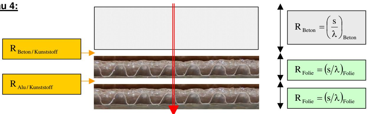
**• Messdaten für den Wärmeleitwiderstand der 4 Varianten des Versuchsaufbaus:**
